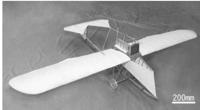
形状を検討するために製作した模型 (尺度: 1/5、翼長:2000mm)
