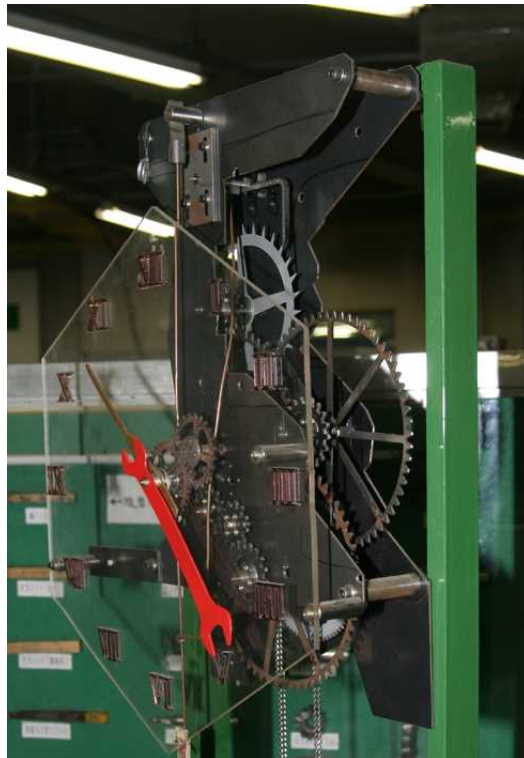
機械式時計の構造を解説する大型模型 (高さ1200mm 付属工高にて製作)
