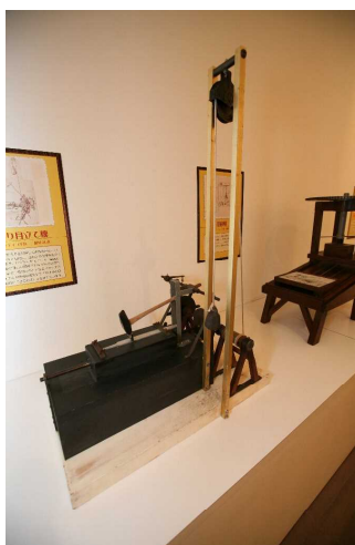
やすりの目立て 機の模型 (高さ 1800mm)
